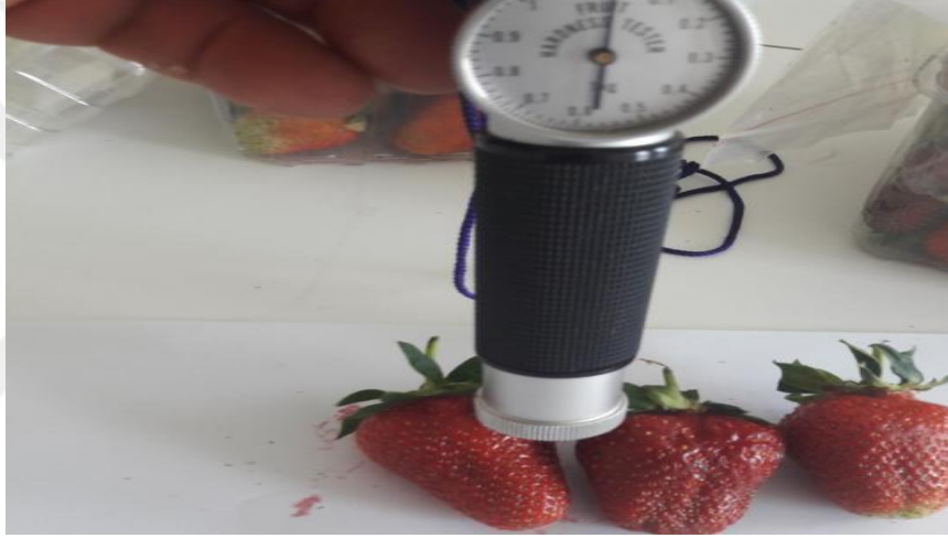
Şekil 3.3.9. Meyve eti sertliği ölçümü
