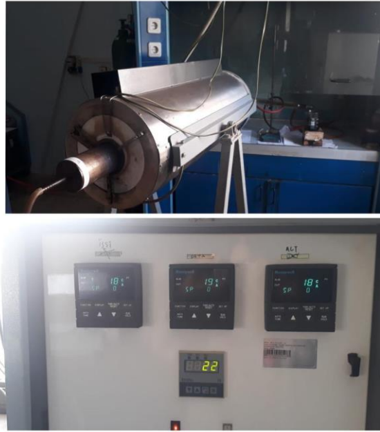
Şekil 1. Karbonizasyon işleminin yapıldığı üç zonlu borusal fırın
